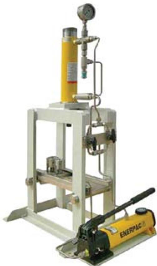
Предназначен для подготовки цилиндрических образцов неконсолидированного керна диаметром 1", 1,5" и 30 мм.
