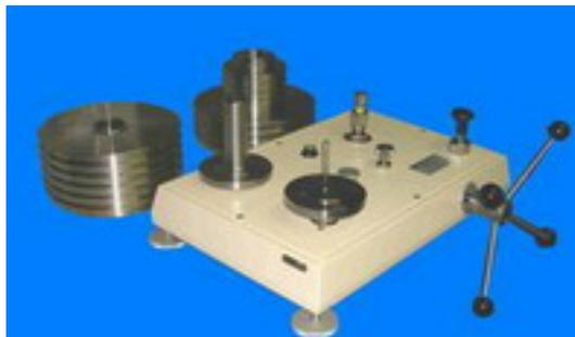
Первичный стандарт давления, разработанный для приложений калибровки высокого давления. Прибор состоит из вертикально смонтированных, с высокой степенью обработки поршней и блок цилиндров. Точно откалиброванные стандартные веса устанавливаются на поршни, которые свободно перемещаются внутри цилиндров. Эти веса уравнивают подъемную силу, созданную приложением давления в пределах устройства. Поставляются с контейнером для транспортировки.
