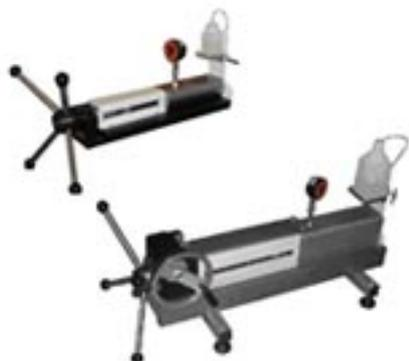
Предназначен для обеспечения гидравлического давления и измерения объема при подачи газ и жидкости в ячейки высокого давления. Насос может быть поставлен с манометром, двумя ручными клапанами для подключения емкости с жидкостью и линии подачи, шкалой для измерения объема и в настольном исполнении. Части контактирующие с жидкостью изготовлены из нержавеющей стали. Ручные насосы имеют широкий диапазон объемов и рабочего давления.
