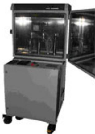
Насосы серии НТР созданы для обеспечения непрерывного потока без пульсаций, в широких пределах давлений и могут работать при температуре окружающей среды или более высокой. Цилиндры насоса синхронизированы и обеспечивают непрерывную подачу флюида при постоянном давлении. Насосы этой серии могут использоваться для различных системах требующих протока либо рециркуляции флюида. Насос оснащается тремя рабочими цилиндрами соединенными через пневмоклапан для заполнения и подачи флюида.
