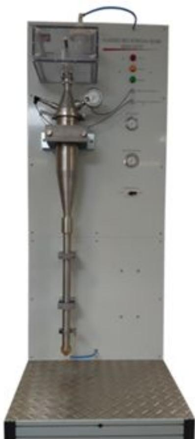
Vinci-Technologies предлагает специальное оборудование, предназначенное для определения характеристик истирания порошковых катализаторов каталитического крекинга в псевдооживленном слое. Установка особенно подходит для испытания свежих или обработанных паром, сферических или нерегулярных катализаторов с размерами частиц от 10 до 180 микрон.
