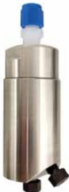
Сепаратор позволяет разделять газовую и жидкостную фазы после выхода из ВРР. Газовая фаза выходит через верхний порт, а жидкостная через нижний. Внутри сепаратора находится поршень, который открывает соответствующий текущей фазе клапан. После разделения фазы можно направить в газометр и коллектор фракций для измерения их объема.
