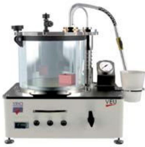
Предназначен для дегазации и стабилизации смолой порошкообразных, сломанных, хрупких, рыхлых образцов горной породы. Одновременно могут пропитываться до 10 образцов. Лампа подсветки помогает следить за процессом дегазации смолы. Опциональный подогрев столика дает возможность снизить вязкость смолы для более быстрого и полного заполнения пор образца.
