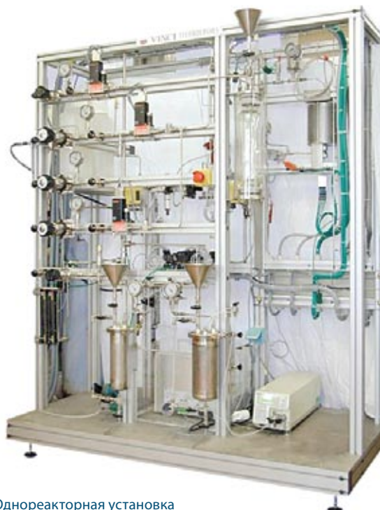
Однореакторная установка с неподвижным слоем катализатора. Блок управления не показан
