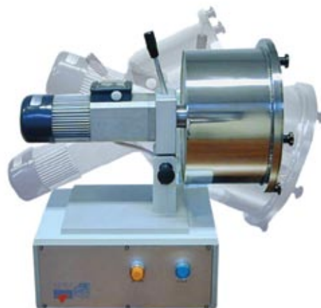
Вращающийся барабан метод ASTM D 4058-96
