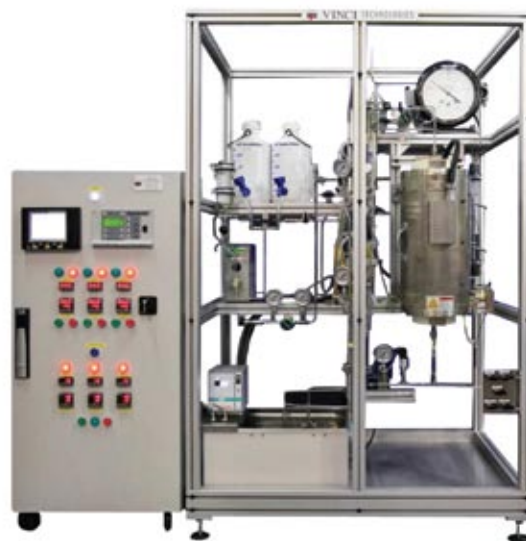
Установка извлечения ртути в газовой фазе
